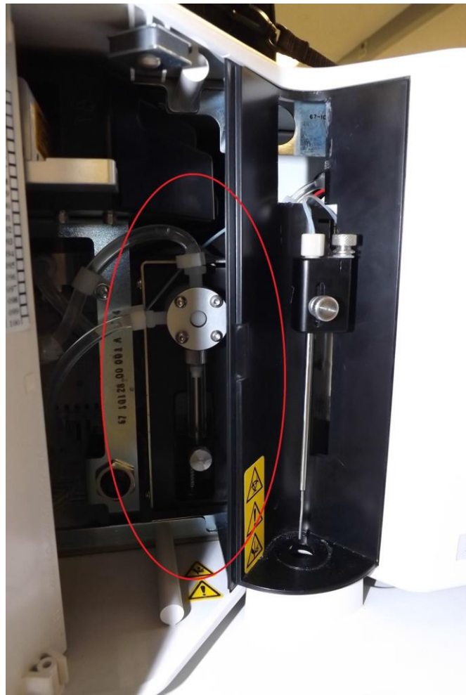
图 10. 在门打开，注射器外露状况下的 Luminex ® 系统的正面视图
