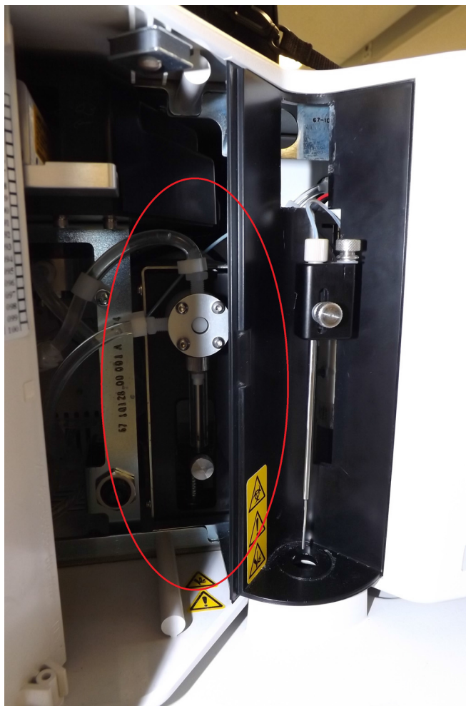
ABBILDUNG 10. Frontansicht eines Luminex®-Systems mit offener Zugangstür und freiliegender Spritze
