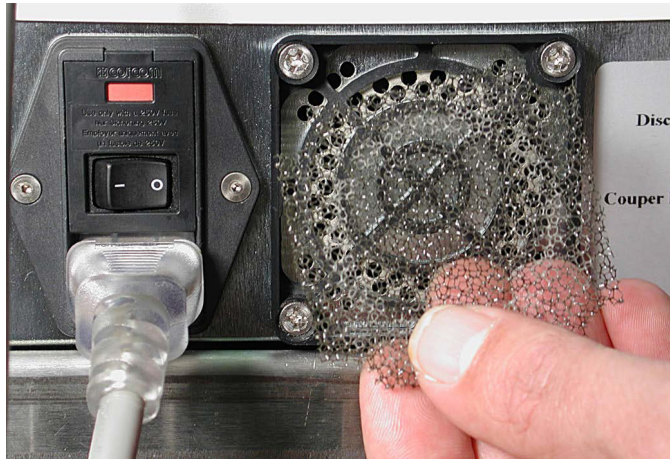
ABBILDUNG 9. Entfernen und Auswechseln des Filters
