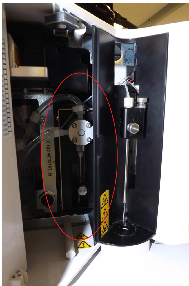
FIGUR 10. Billede af et Luminex®-system med åben dør og synlig sprøjte set forfra
