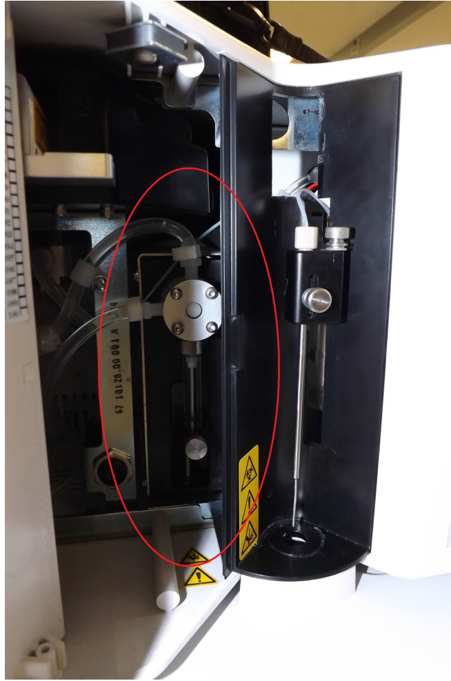
圖 10. Luminex® 系統正面圖，打開檢修門並露出針筒
